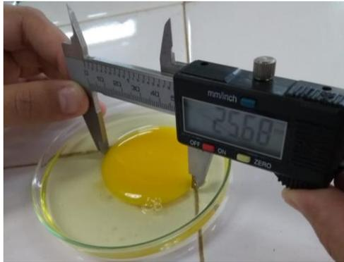
Figura 5: Medição do índice de gema de ovos brancos de galinha, por meio de paquímetro digital.
